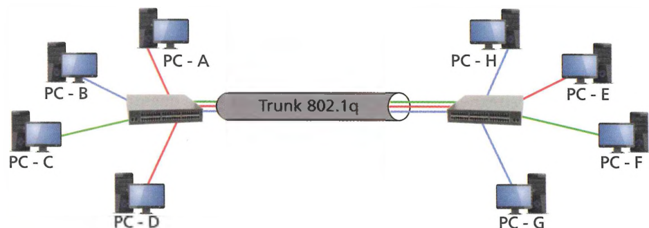
FIGURA 8 Rappresentazione di un trunk usato per mettere in comunicazione 3 diverse VLAN
